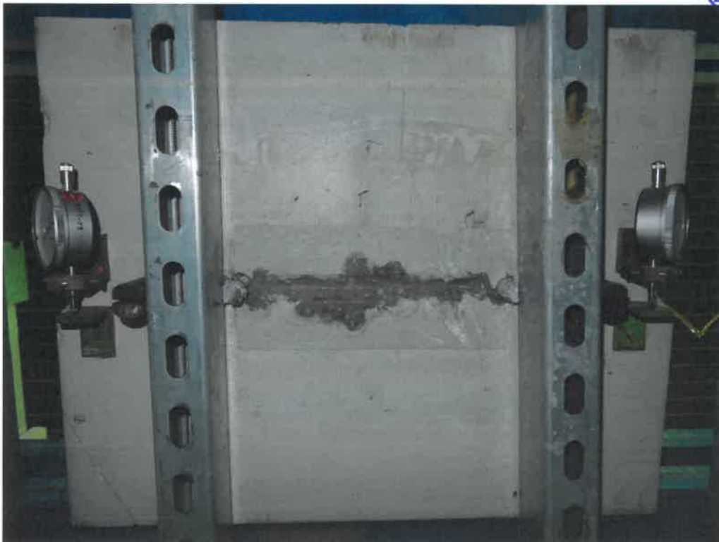
Bild 6 Unterseite Prüfkörper 3 mit Crystal-Proof L1 während des Versuches
